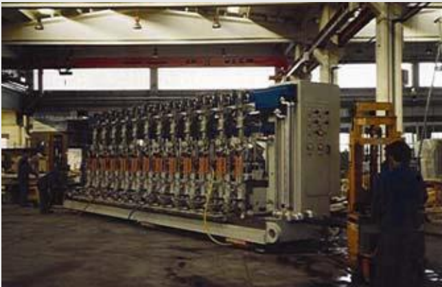
Flaschen-Maschine, 40 Tonnen. Mit freundlicher Genehmigung von Bottero, IT-Cuneo.
