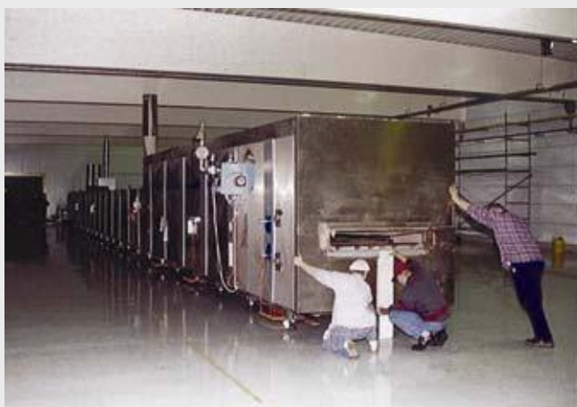
Ein 27m langer Ofen mit 18 Tonnen Gewicht wird ohne Anstrengung auf Luftkissen bewegt und präzise positioniert. Das Demontieren von langen und empfindlichen Anlagenteilen entfällt.
