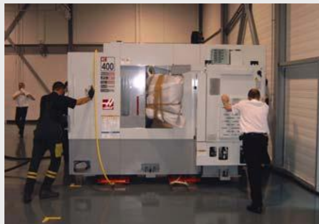
Das Bewegen auf Luftkissen ist einfach, hält Böden sauber und beschädigt sie nicht. CNC-Maschine, 10 Tonnen.
