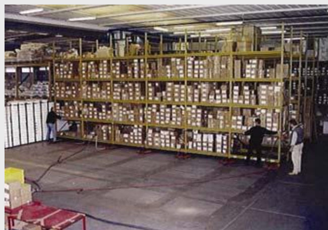
Das Bewegen von 3 Regalreihen mit jeweils 10 Tonnen Gewicht in 2 Stunden und mit nur 3 Personen anstatt in 1 Woche und mit 8 Personen.
